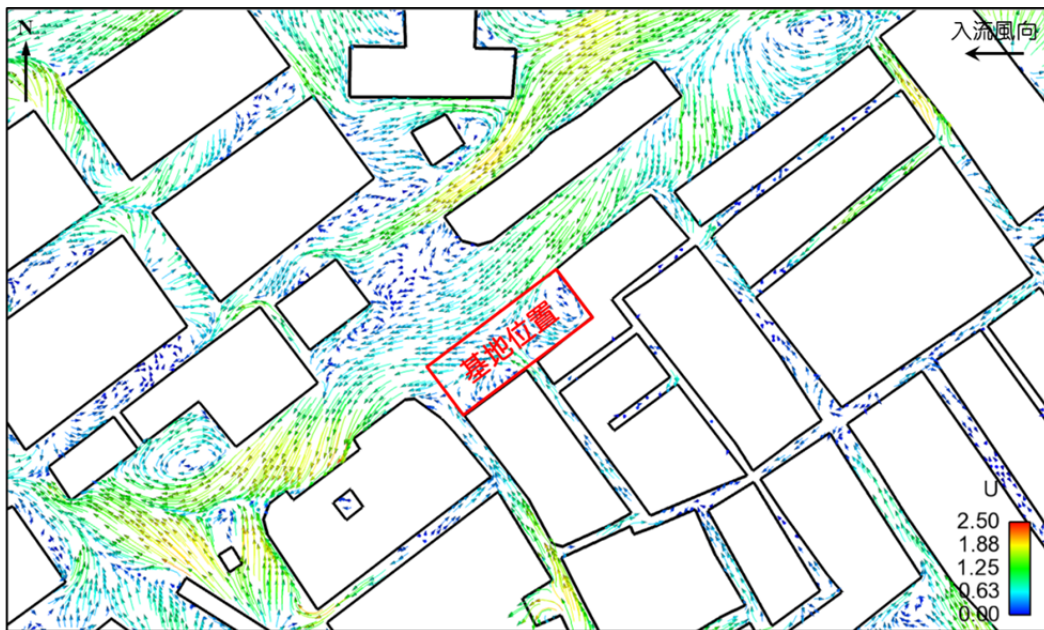
圖 4.8 盛行風向（東風）下行人高度（H=1.5 m 處）風速向量圖—興建前
