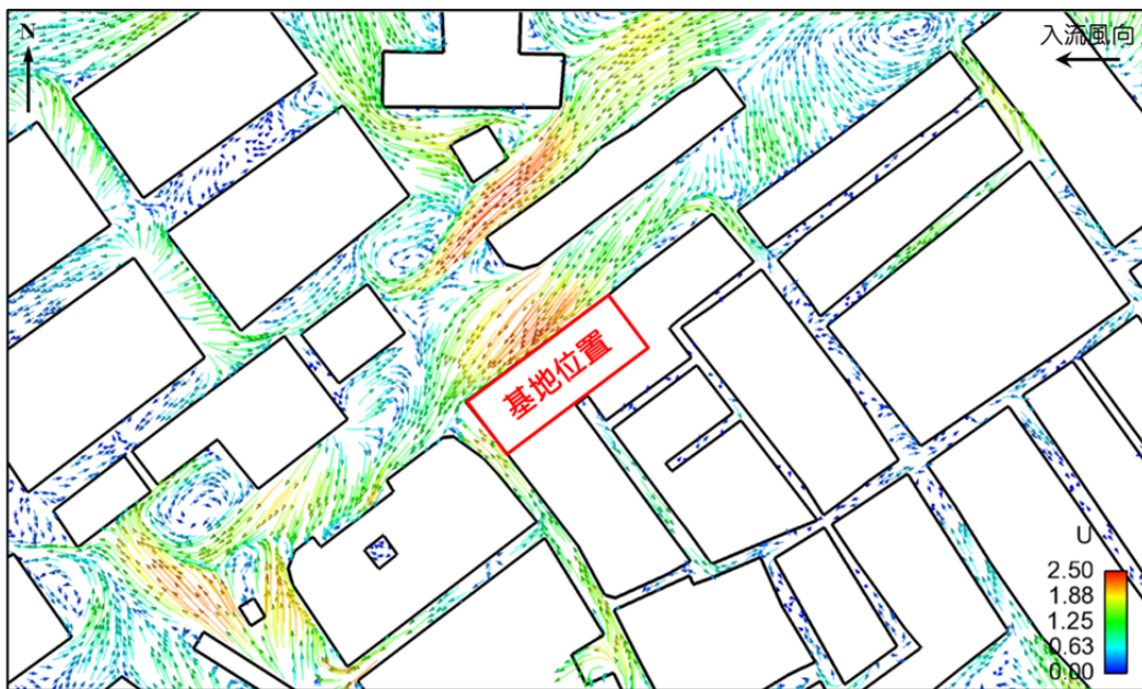
圖 4.9 盛行風向（東風）下行人高度（H=1.5 m 處）風速向量圖—興建後
